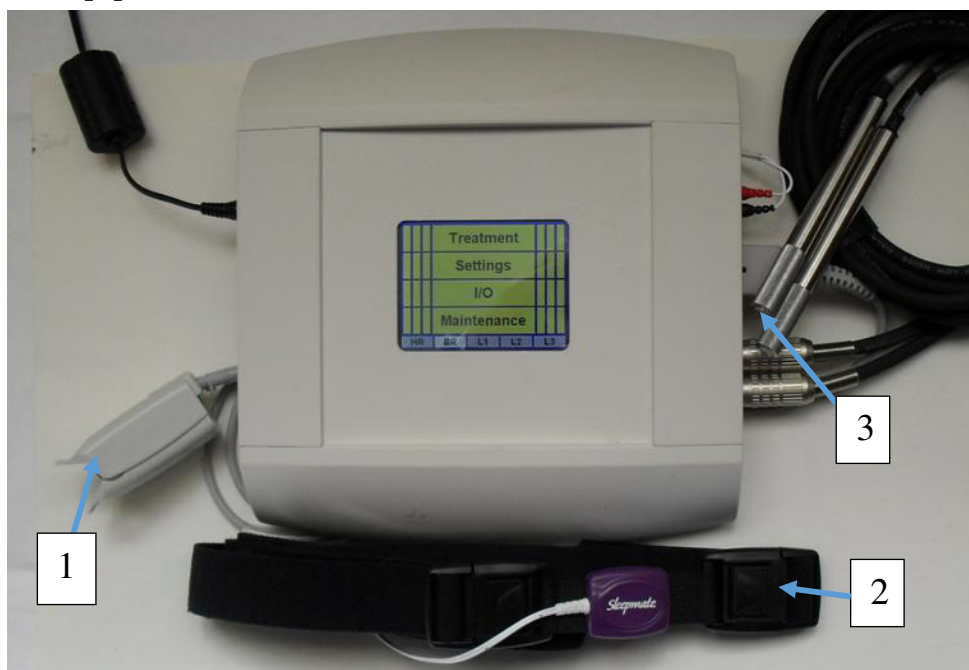
Рис. 1. Программно-аппаратное устройство биоуправляемой лазерной терапии. 1- датчик пульса, 2- датчик дыхания, 3- лазерные диоды.
